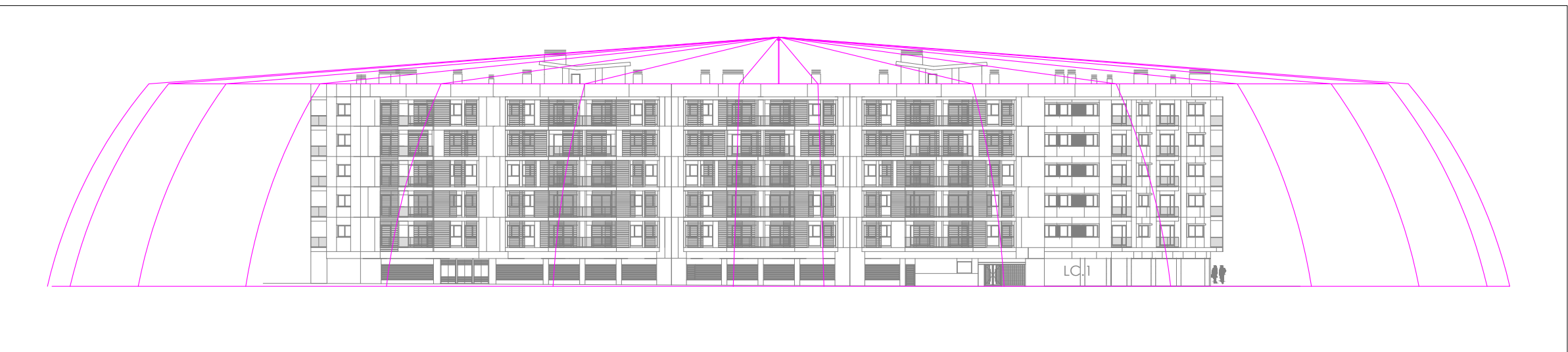
COBERTURA PARARRAYOS. SECCIÓN ESCALA 1:500
